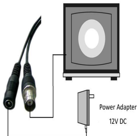
Рис. 6.1.1. Коммутация разъемов видеокамеры
